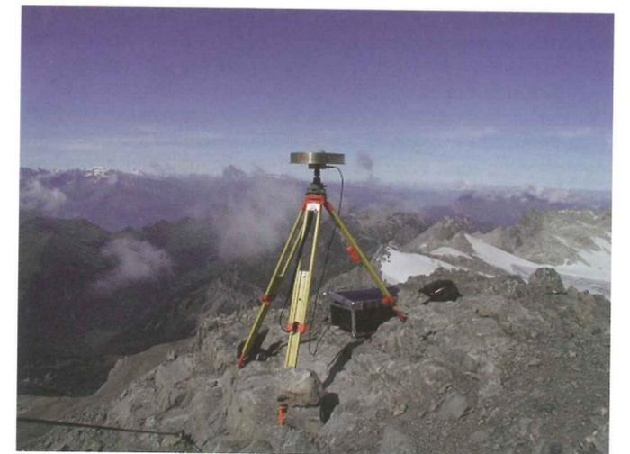
Abb. 16.: GPS-Messstation
